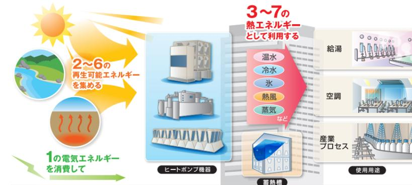
ヒートポンプ機器は、熱と圧力の性質を利用して、空気をはじめ河川や地中、海水などの自然の熱\* (再生可能エネルギー)を「集めて」、必要に応じて「運ぶ」ことによって、冷房・暖房や給湯をはじめ、工場の製造工程などにも利用されています。また、蓄熱槽と組み合わせることにより、電気需要最適化と省エネルギーを同時に実現することができます。
